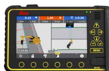
Schermata di esecuzione per escavatore con brandeggio
